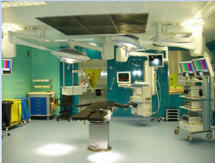
▷**ESTRUCTURA:** Techos continuos, Paredes lisas sin juntas ,resistente y de fácil limpieza, Suelo resistente,conductor y continuo, Puertas automáticas y herméticas-no de vaivén.
